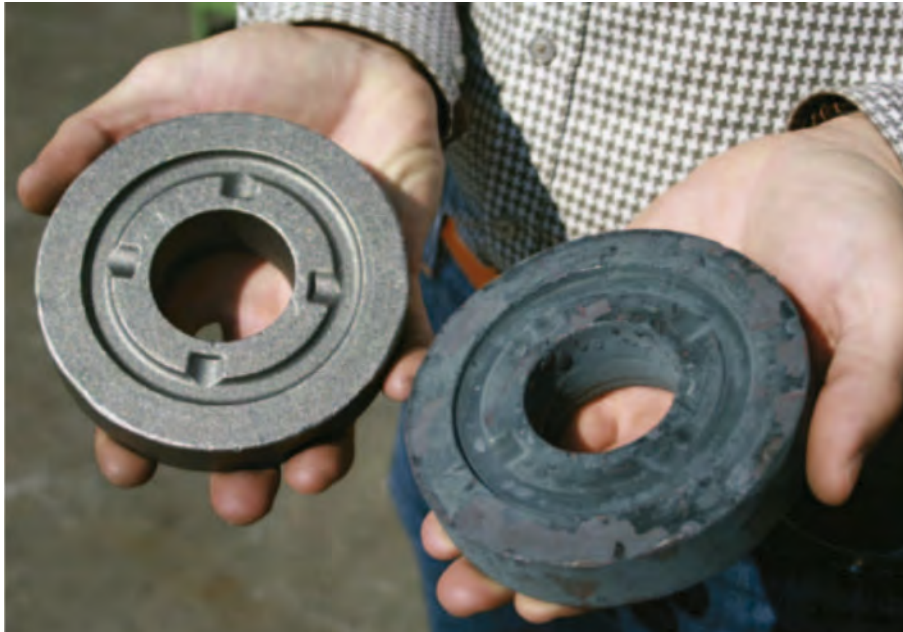
Piezas antes de granallado (derecha) y después de granallado (izquierda).
