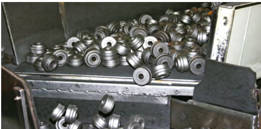
Limpie las piezas después del proceso de limpieza. La granalla es una mezcla especial de redonda y angular con la dureza controlada.
