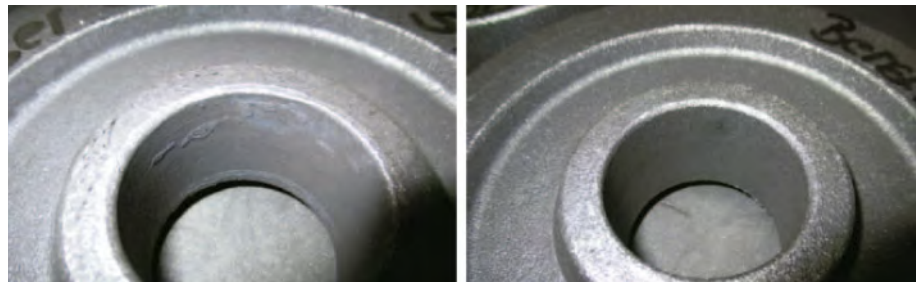
Pieza Cotarko después de cinco minutos de granallado con granalla de bajo-carbono (izquierda) y la misma pieza granallada el mismo tiempo con la mezcla especial Ervin (derecha).
