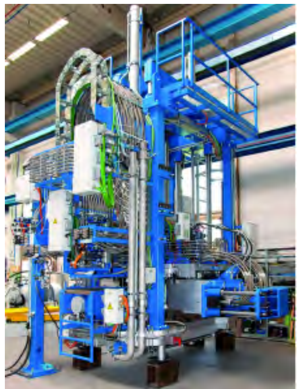
Máquina de coquillas de colada a baja presión Kurtz AL 18-12 SO para gran productividad en la fabricación de cajas de cigüeñales de gran calidad, para motores de cuatro cilindros en línea de aluminio.
