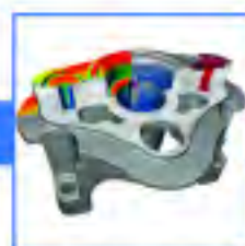
Comparación entre TC y CAD mostrando defectos no críticos en una zona a mecanizar
