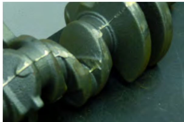
Manual. Rebabado defectuoso, excesivo en línea de partición.
