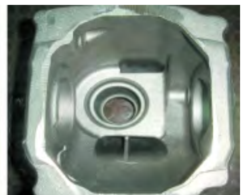
Arena 55 AFS GFN + 5 % ISOSEAL™ 2011, sin recubrimiento - 1,5 % caja fría 419/619
