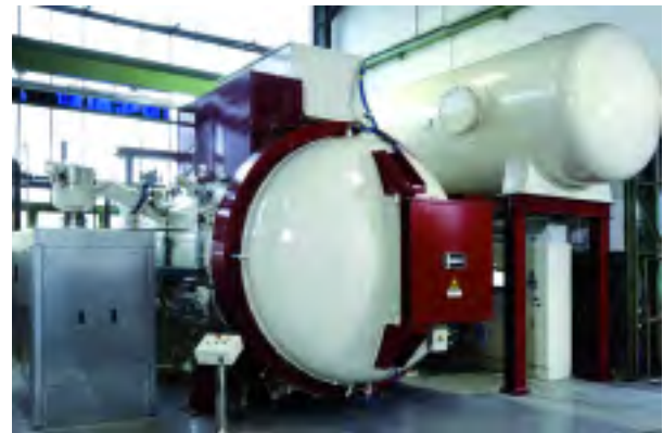
Figura 8: Nuevo horno de vacío para el proceso de temple Ipsen Turbo Treater ST6672 en Kind & Co.
