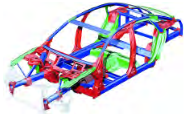
Figura 1: Componentes de aluminio obtenidos por fundición inyectada (rojo) en la carrocería del AUDI A8 [4].
