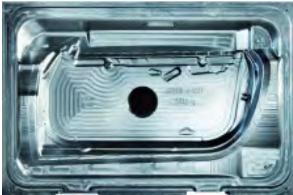
Figura 9: Inserto del molde para la puerta de un coche para pasajeros, 3.820 kg.
