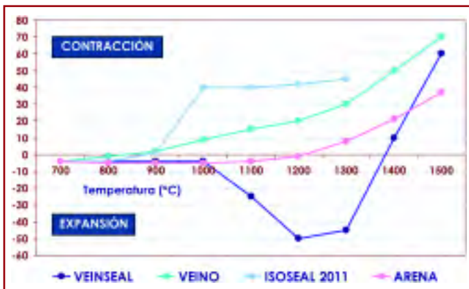
Figura 9: Comportamiento de la Contracción de diferentes mezclas de aditivos con arena de Sílice.
