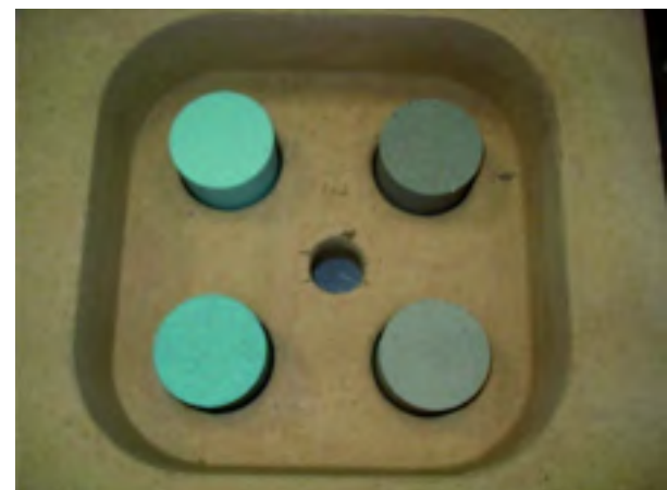
Figura 5: Probeta para la evaluación del Veining.
