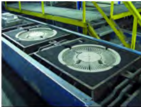
95% Arena recuperada de moldeo en verde + 5% Isoseal™
