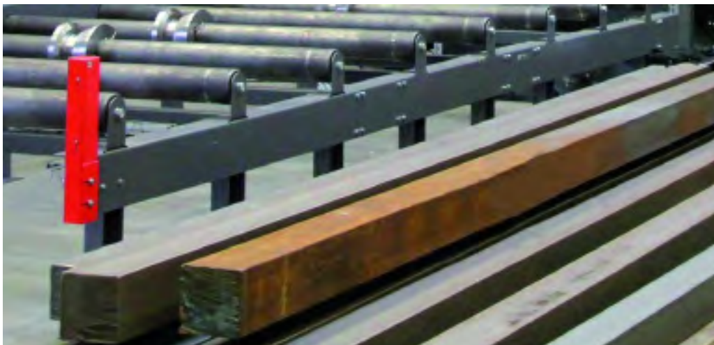
Los estándares de calidad exigen una superficie libre de óxido/calaminas y con un grado de limpieza de SA 2, partiendo de una superficie inicial con grado de oxidación "B".
