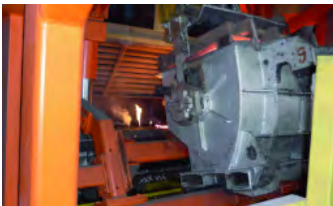
Figura 5: Los dos autómatas de colada de HWS en aplicaciones tecnológicas diferentes.
