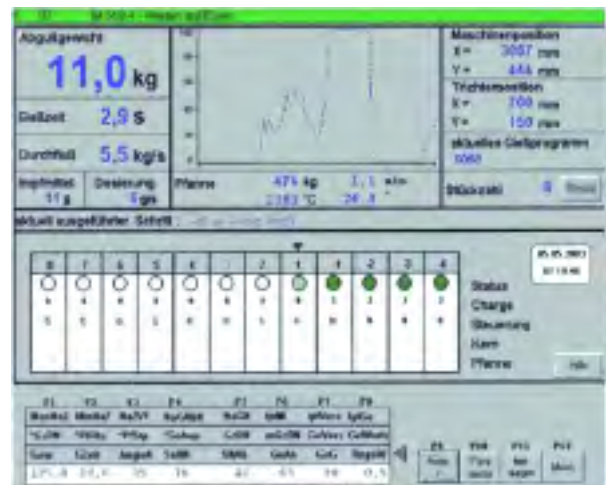
Figura 6: Visualización de los parámetros de colada en el monitor del control de HWS en tiempo real.
