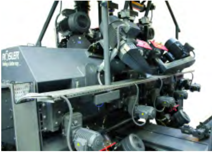
La RKL 8-55/180 está equipada con ocho turbinas Rösler de larga duración modelo 520 diseñadas por Rutten con una potencia de 55kW cada una.
