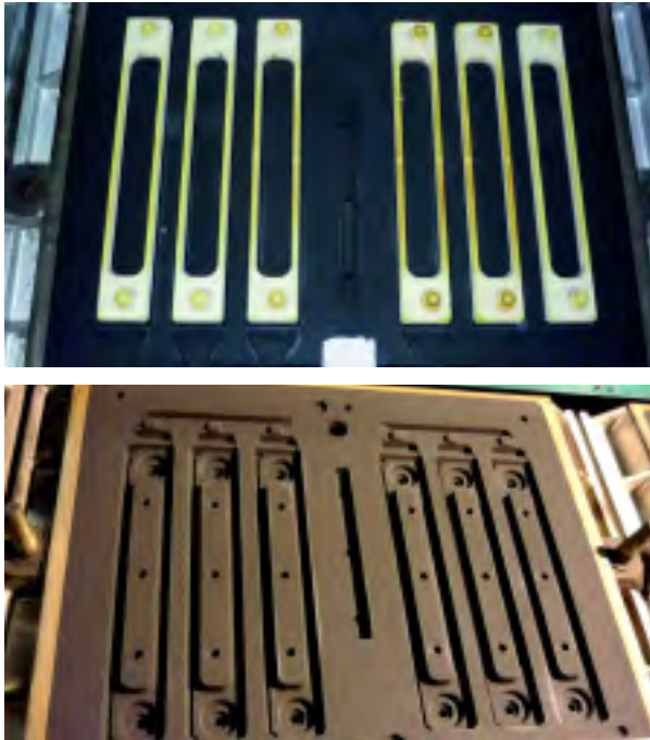
Figura 2: Las cajas de moldeo para segmentos de calefacción (radiadores) en la zona de colocación de machos de la línea de moldeo de HWS: Caja inferior con machos (centro) y caja superior (derecha).
