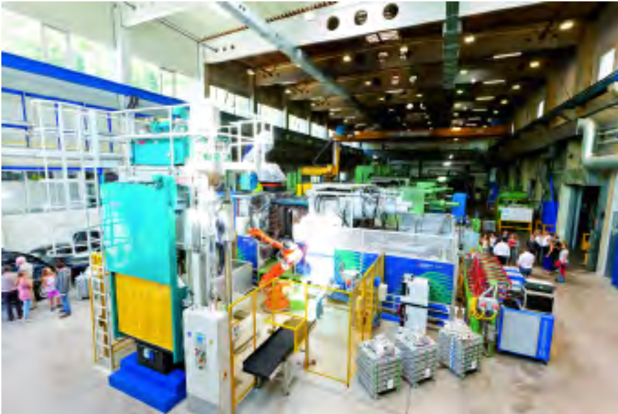
La nueva instalación de fundición a presión de GF Automotive en Altenmarkt (Austria).
