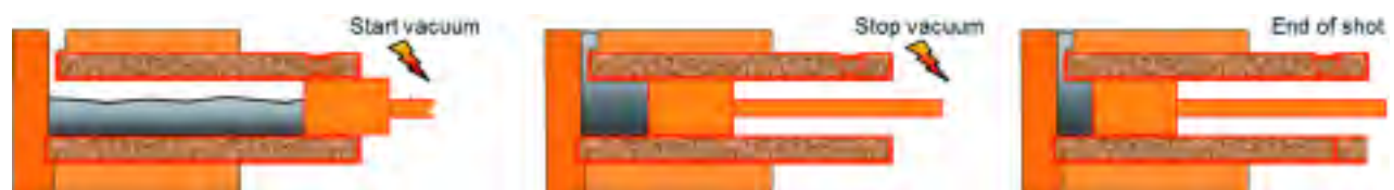
Figura 3. Principio de control de la válvula de vacío Ultra.
