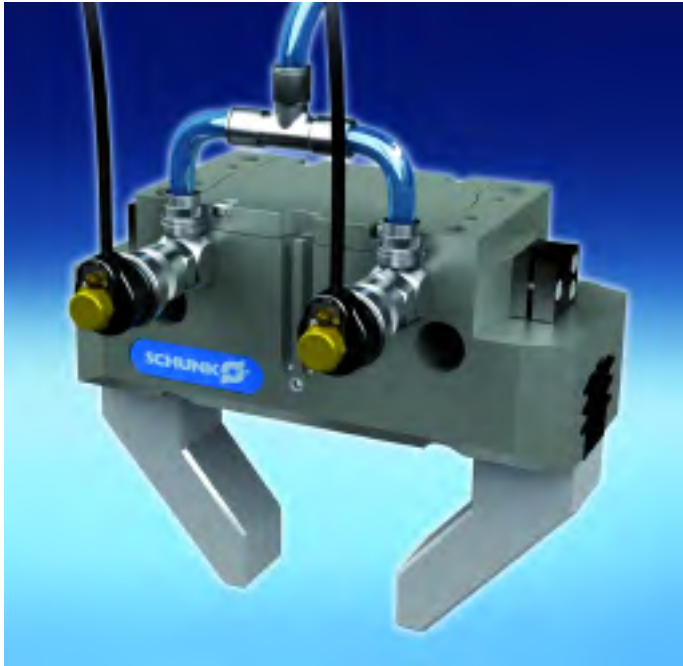
PGN-plus. Las microválvulas, pueden ser integradas directamente en cada uno de los actuadores. Reduciendo así el consumo de aire comprimido y acortando los tiempos de ciclo.
