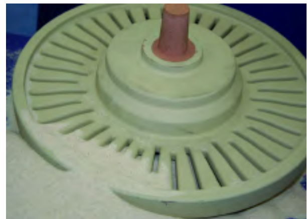
Figura 5. MIRATEC BD evita los defectos de veining en la junta.
