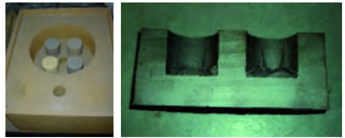
Figura 3. Los machos 2 x 2 y el molde (izquierda), y una pieza seccionada (derecha) presentando defecto veining.
