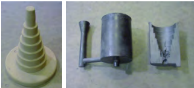
Figura 2. Macho de cono escalonado (izquierda), pieza de fundición (centro) y pieza seccionada (derecha).
