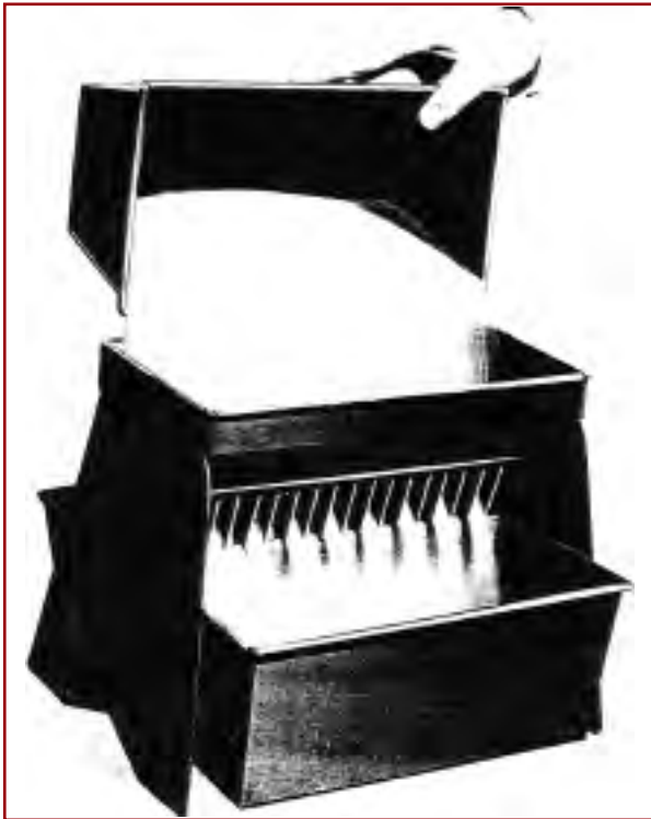
Figura 2. Divisor mecánico de salidas múltiples.
