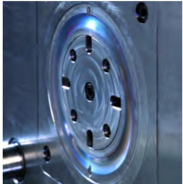
Imagen 3. Foto Plasmamatreat. Ópticamente visible: La parte de azul claro muestra el nano recubrimiento de anti-adhesión PT-Release en la superficie de acero.
