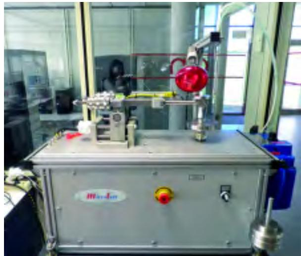
calentador por radiación infrarroja que permite alcanzar hasta 100 °C de manera controlada y un sistema de lubricación automático. El rango de cargas va desde 1 N hasta 30 N y tiene una velocidad angular máxima de 600 r.p.m. Puede realizar ensayos de fricción y desgaste tipo ball-on-disc o pin-on-disc. Además, permite la realización de ensayos circulares y de recíproco.
