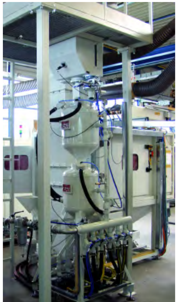
Con el contenedor de doble presión se realiza una operación de chorreado sin interrupción.
