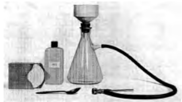
Figura 6. Aparato tipo PWA, para medir la capacidad de absorción de agua de las arenas.
