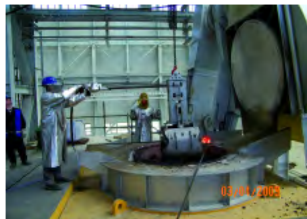
Imagen 7: Horno de 40 toneladas con campana de aspiración abierta.
