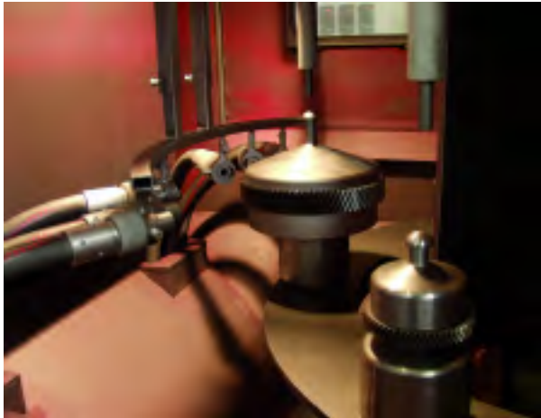
Excelente efecto peening – este sistema produce niveles de tensión compresiva de hasta 1.500 MPa.
