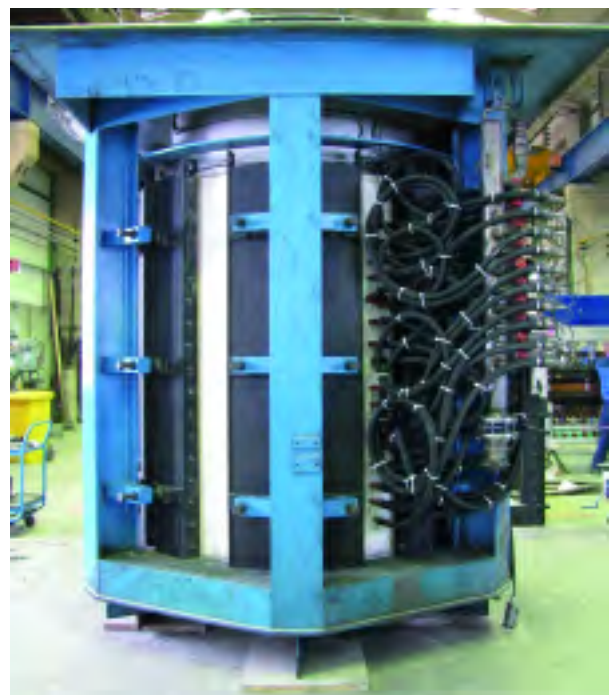
Figura 3: Horno de crisol con bobina de ahorro de energía instalada.
