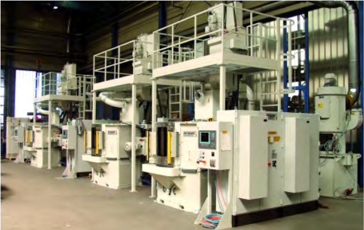
Excelente efecto peening – este sistema permite niveles de tensión compresiva de hasta 1.200 MPa.
