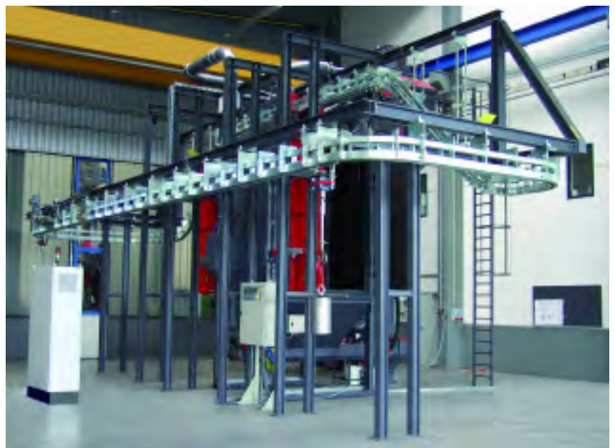
Además de requerir una alta productividad, resultados excelentes de granallado y un coste eficiente de la máquina de granallar en continuo con transporte mediante railes, las especificaciones de KAMAZ detallaban un diseño sin foso. Se incluyó un sistema monorail equipado con tres bastidores que permiten simultáneamente la carga, granallado y descarga de las piezas.
