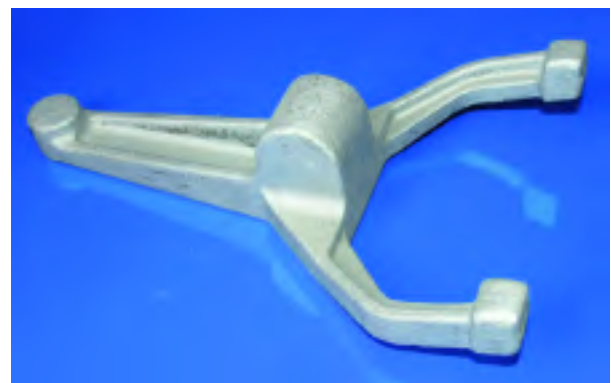
Tras la forja, varias piezas como estas horquillas son decalaminadas y desoxidadas en lotes. Las especificaciones de acabado de superficie eran SA 2.5, “metal casi blanco”.
