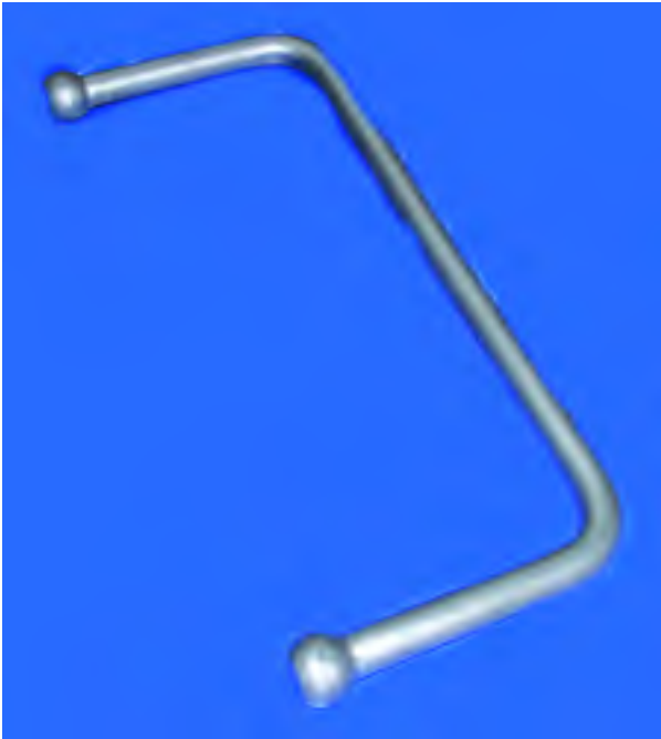
El decalaminado y desoxidado de los forjados como este travesaño del eje delantero se realiza en la RHBD 15/20 T. Tras mecanizar la pieza, también se le aplica un shot peening para inducir tensión residual de compresión en la superficie de la pieza.
