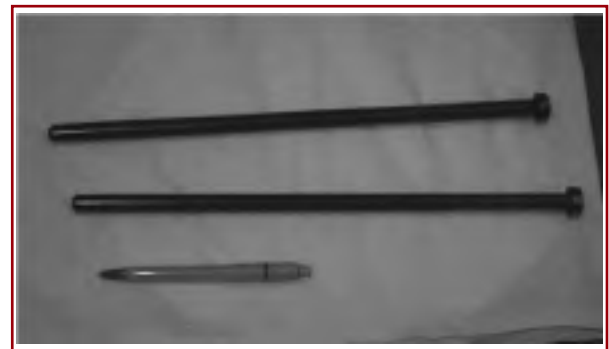
Fig. 11. Insertos de acero AISI 1.2344 nitrurados para inyección de aluminio.
