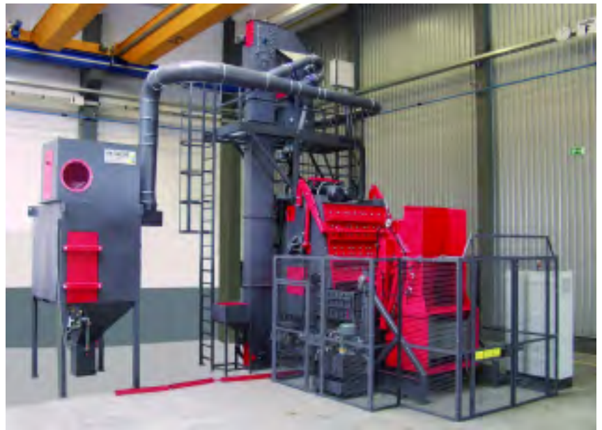
El modelo de alta resistencia RMBC 8.2-SB está equipado con dos turbinas de alto rendimiento con 22 kW de potencia cada una, para granallar hasta 8 toneladas de forjado por hora. El diseño único de los discos facilita el mantenimiento, especialmente en el rápido reemplazo de las palas.
