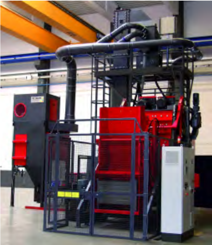
La carga de la granalladora a cinta tapiz se realiza con un cargador hidráulico con un sistema de doble oscilación que asegura al 100% el vaciado de las piezas del contenedor.
