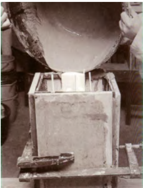
Figura 7. Sistema de moldeo horneado, proceso de colada del material refractario.
