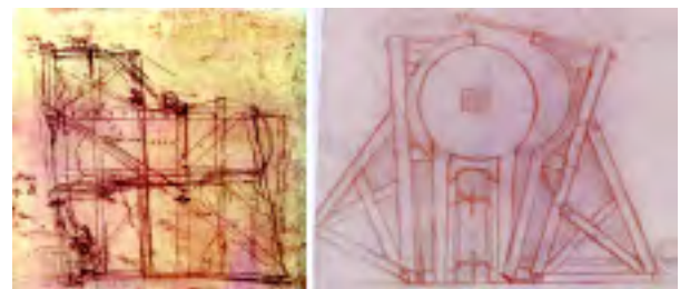
Figura 4. Armazón para la construcción del modelo.
