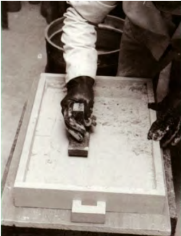
Figura 6. Sistema de moldeo químico.
