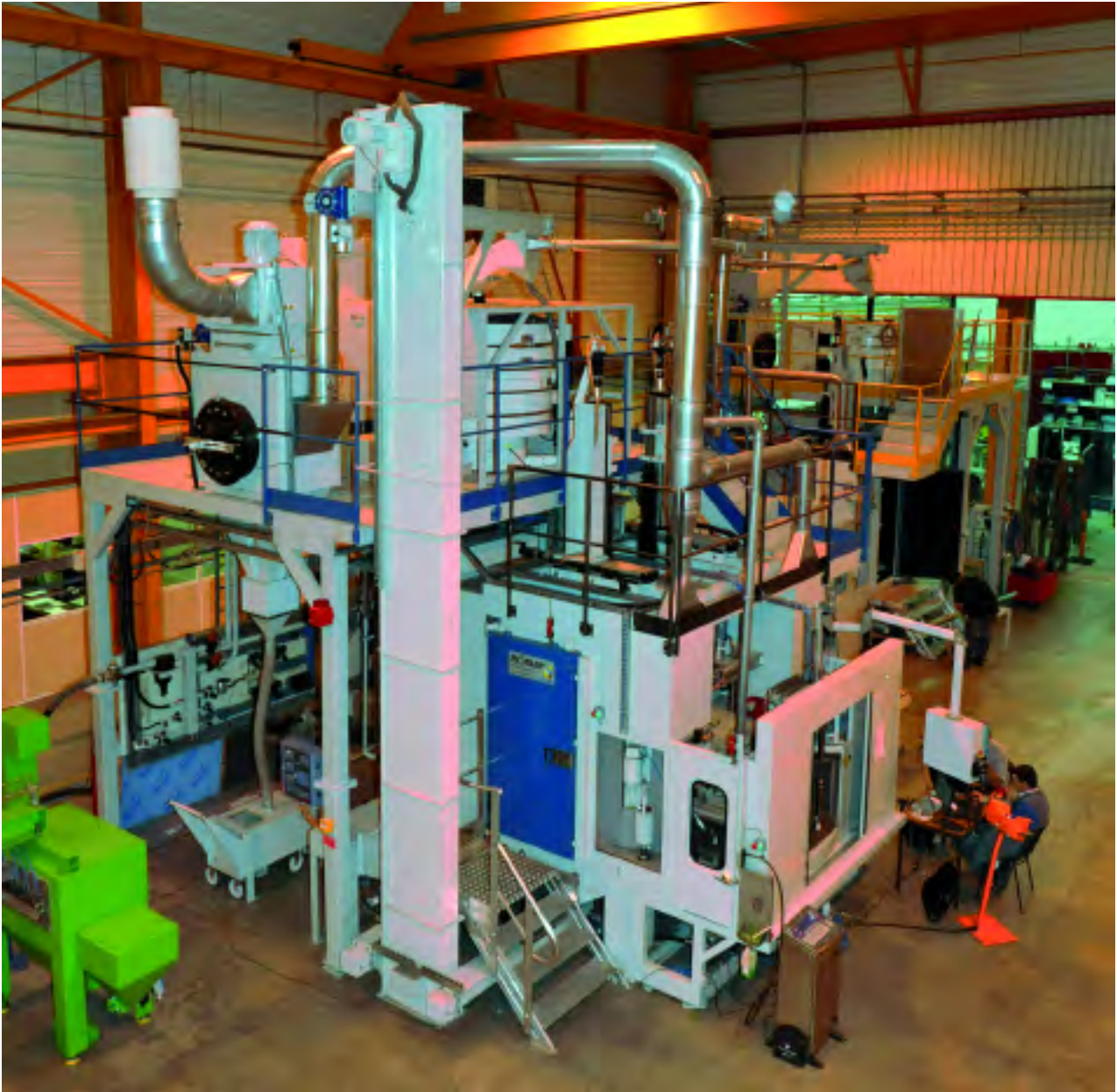
Sistema Rösler de shot peening con cinco estaciones de trabajo, equipadas cada una con dos satélites, que permite el shot peening simultáneo de diferentes componentes de transmisión, con dos tipos diferentes de granalla.
