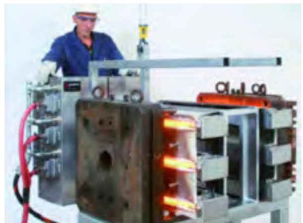
Foto 4. Quemador industrial de promeos GmbH para el calentamiento de moldes de colada a presión.
