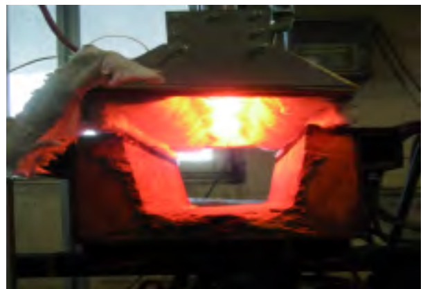
Foto 3. Quemador industrial de promeos GmbH para el mantenimiento de calor en los distribuidores de colada continua.
