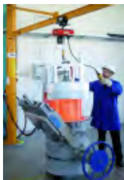
Foto 2. Quemador industrial de promeos GmbH para el calentamiento de recipientes para el transporte de metal líquido.
