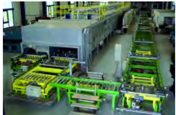
Figura 2: Secadero continuo Tipo TG 55 D con enfriador, Potencia: 650 kW.
