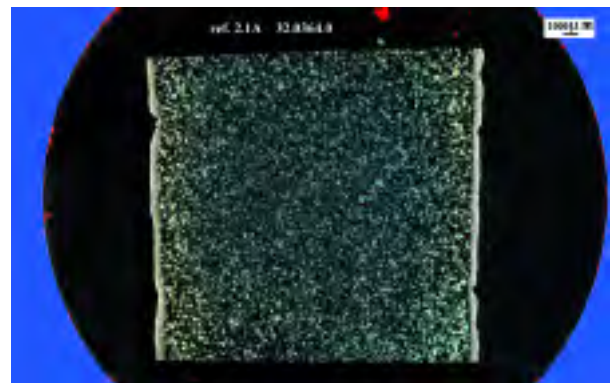
Macroestructura del acero Hadfield con aleante.
