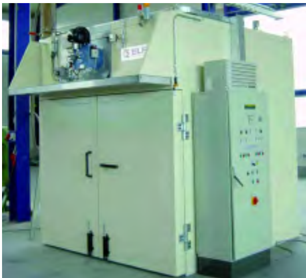
Figura 1: Secadero de cámara Tipo TG 8 K, Potencia: 325 kW.
