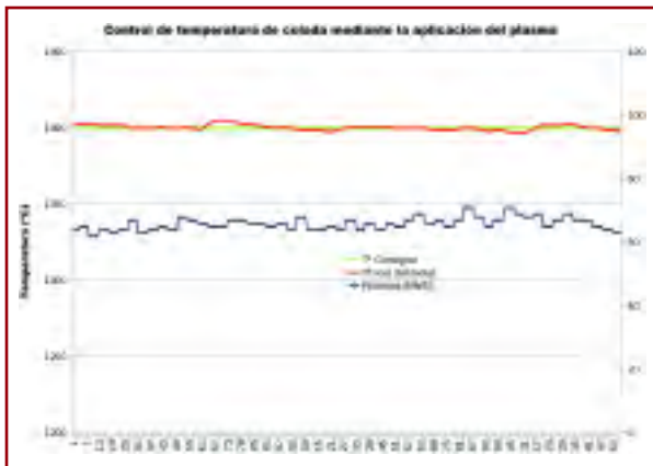
Fig. 5. Vista gráfica de la evolución de la temperatura de colada y la aplicación continua de la potencia del plasma en una unidad de colada automática.
