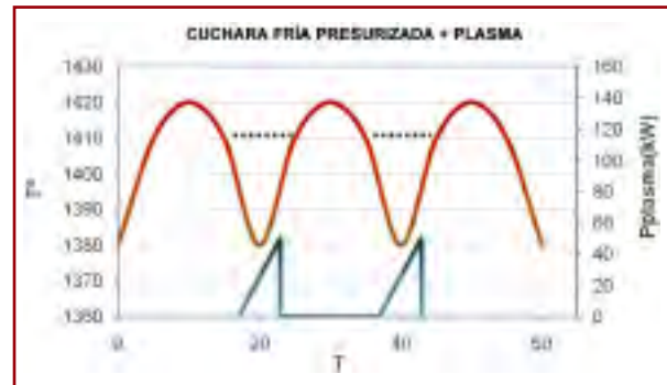
Fig. 6. Esquema del amortiguamiento de la Tª de colada en una cuchara presurizada.
