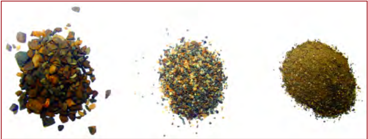
Figura 1. Distintas granulometrías del árido: mayor de 2mm, entre 2 mm y 0,6 mm, y menor de 0,6 mm, respectivamente.
