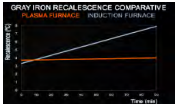
Fig. 12. Gráfica que muestra la evolución en el tiempo de la recalescencia.
