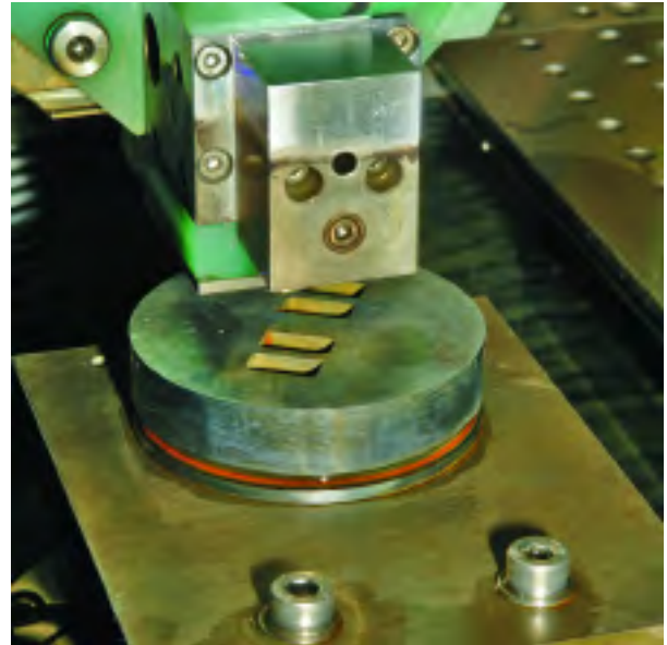
Las partes pasantes para las 4 figuras se realizaron mediante electroerosión por hilo con una gran precisión en una AC Challenge 3V con una rugosidad de superficie de Ra 0.6 \mu\text{m} y una tolerancia de contorno de \pm 2 \mu\text{m} .
