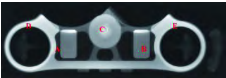
Fig. 10. Muestra con un llenado en régimen laminar. Únicamente se observa un defecto en la zona C, y es debido al desgarro producido en la extracción de la galleta.
