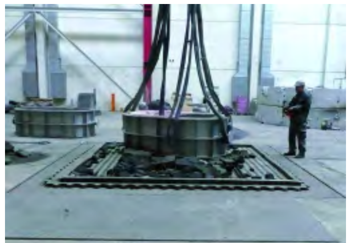
Parrilla de desmoldeo 4,2 x 4,2 m con una sobrecarga de 50 t.
