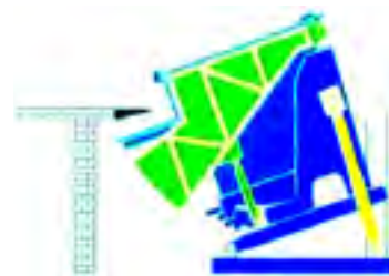
Dibujo del principio del basculamiento trasero.
