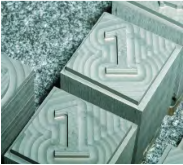
El electrodo de grafito R8710 para el «uno» se produjo en una Mikron HSM 300 Graphitmaster mediante el desbastado y el afinado con una calidad de superficie de VDI 7.
