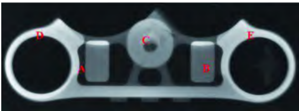
Fig. 9. Muestra con un llenado en régimen turbulento. Rechupe en C y porosidad pequeña en zonas A y más fina en D.
