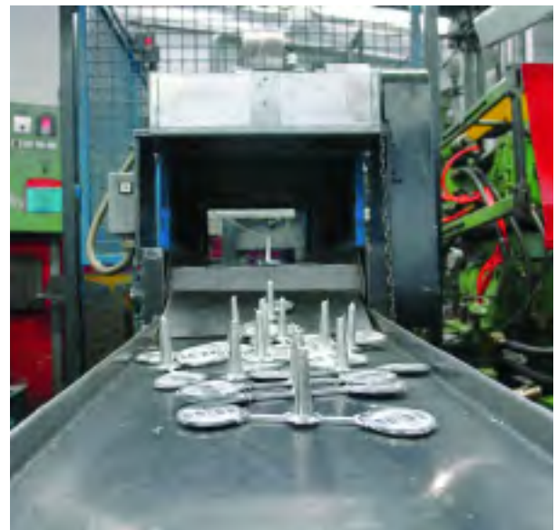
En las monedas ya fundidas se ve que la herramienta de fundición a presión está diseñada con un molde de dos fases para un gran número de piezas.
