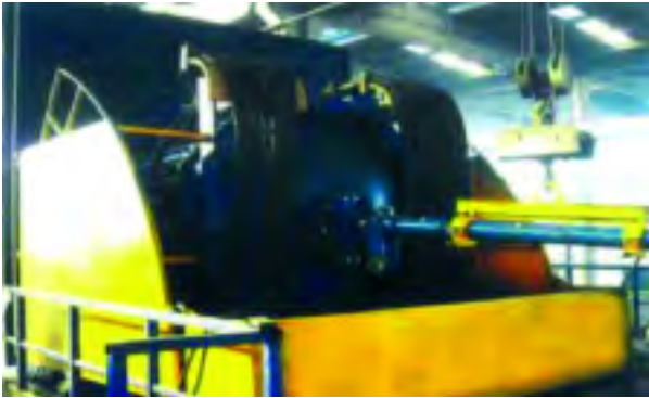
Sistema de Extracción de un horno de 18 toneladas y accesorios de protección laterales.
