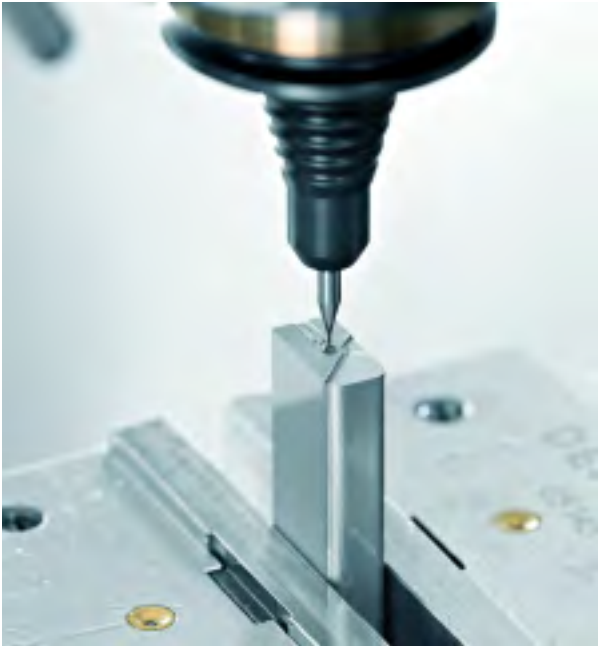
Las 4 figuras en los que se fresaron los símbolos con una Mikron XSM 400U.
