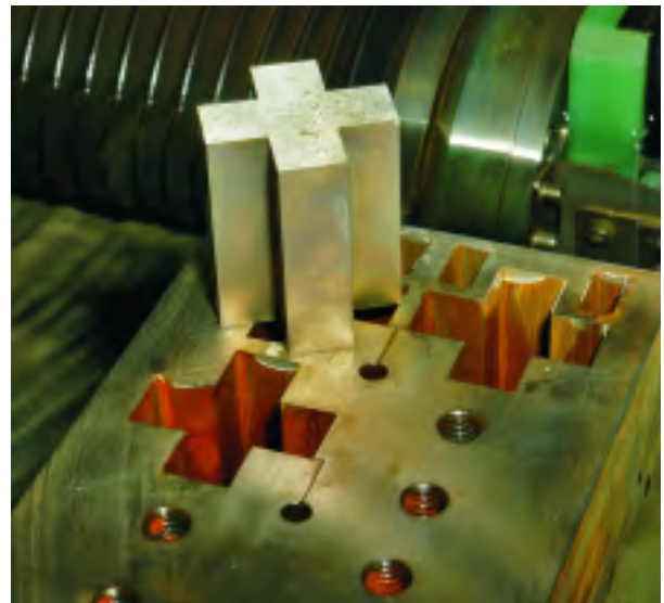
La «cruz suiza» se realizó mediante electroerosión por hilo como figura en una FI 440 CC con una calidad de superficie de Ra 0.6 \mu\text{m} y una tolerancia de contorno de \pm 2 \mu\text{m} .
