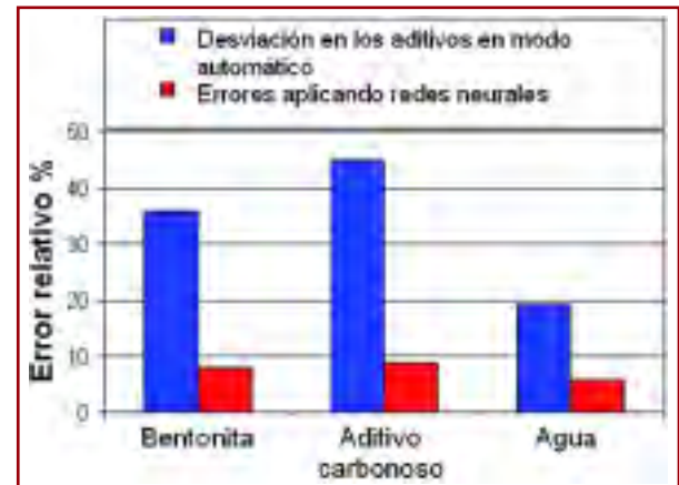
Fig. 36. Reducción de los errores de dosificación en la preparación de arenas de moldeo.
