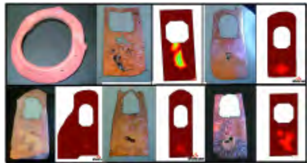
Fig. 32. Simulación de defectos de solidificación.
