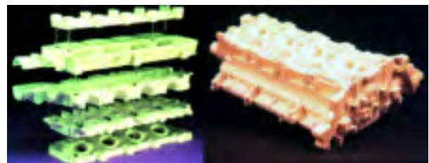
Fig. 8. Modelo de PSE antes y después del ensamblaje.
