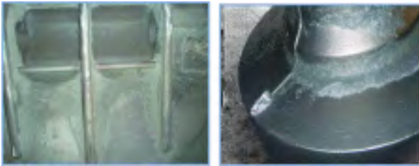
Figura 11. Penetración con Arena Recuperada con alto contenido en Na y K.
