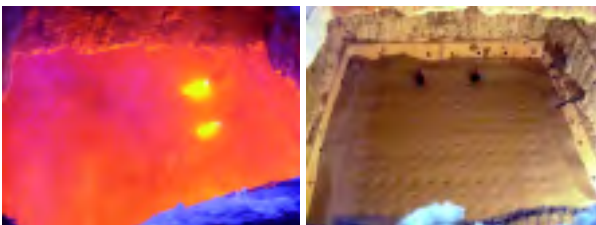
Figura 13. Recuperador Térmico para Arena de Fenólico Alcalina.
