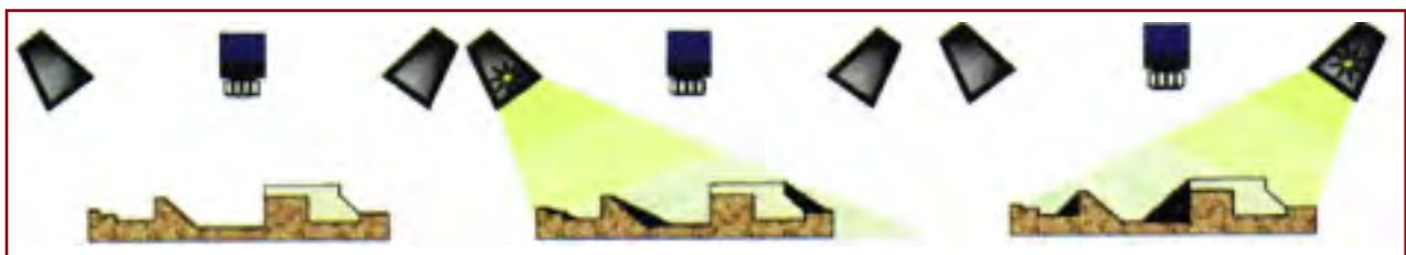
Fig. 16. Aplicación de la modulación de sombras al control de piezas.
