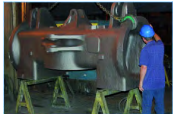
Figura 14. Piezas fundidas con Arena Fenólico Alcalina recuperada Térmicamente con el aditivo NOVATHERM®.
