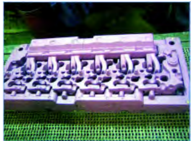
Figura 20. El Recubrimiento tiene un color cuando está húmedo.
