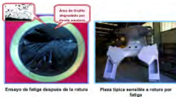
Figura 9.C. Piezas con zonas de degradación gráfica propensas a rotura por fatiga.
