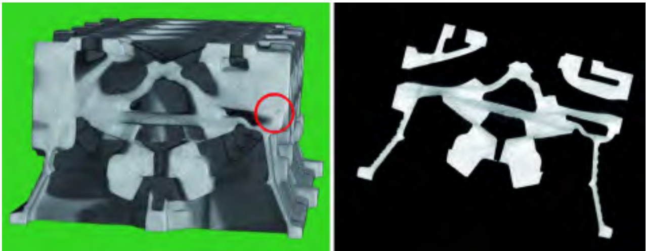
Fig. 18. Inspección por tomografía computarizada.
