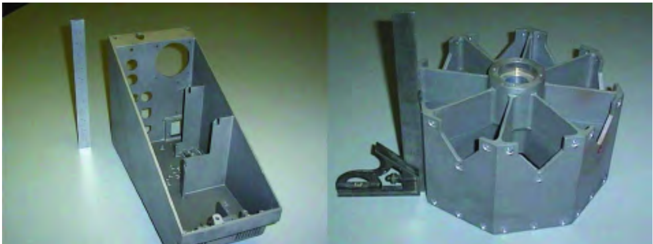
Fig. 7. Ejemplos de piezas de V-Process. No son necesarios los ángulos de salida.
