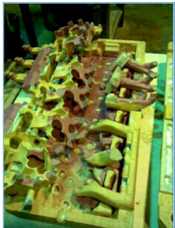
Figura 21. El Recubrimiento tiene otro color cuando está Seco.
