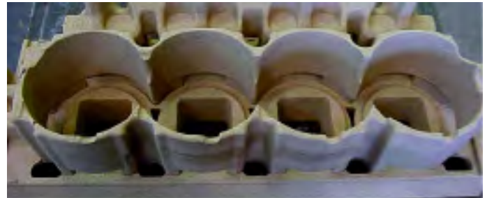
Arriba se representa la configuración del conjunto en el que se puede ver el macho sin ningún tipo de venteo. En la imagen de la izquierda cuando se produce el vertido de material, se manifiesta la generación de gas que fluye a través del metal fundido hasta la superficie formando grandes burbujas superficiales.
