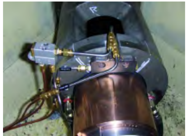
Pistón AMP-R con Allper Combi-Lub (ACL).
