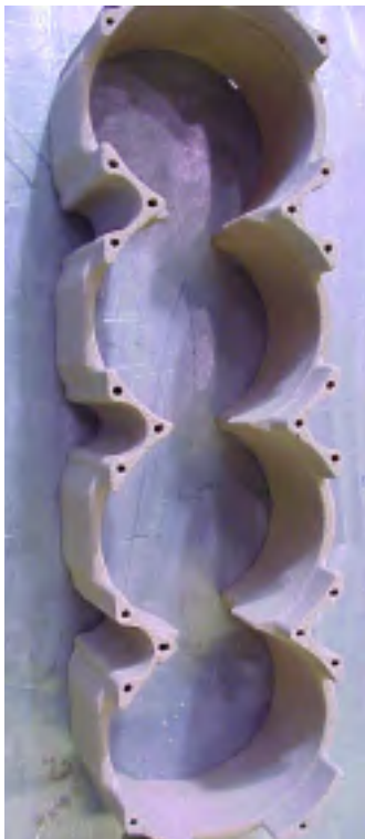
A la izquierda se representan los taladros realizados para ventilar los machos. En la simulación realizada se comprueba cómo desaparece el flujo de gas producido en los machos. Simulaciones realizadas mediante FLOW-3D, cortesía de Flow Science Inc.
