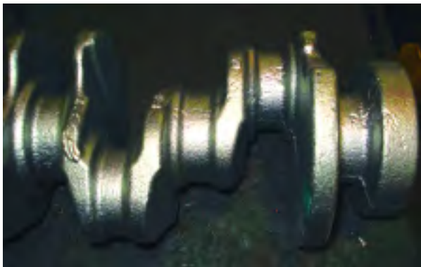
Fig. 3. Imperfecciones superficiales alineadas con la dirección del flujo de derecha a izquierda en un eje de cigüeñal, debido a una velocidad excesiva del metal entrante en la mazarota.
