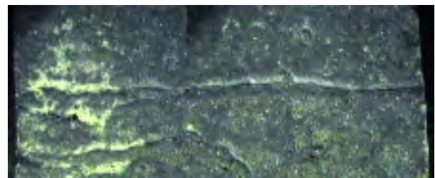
Fig. 6. Pliegues debido a oxidación superficial en una pieza en hierro nodular.
