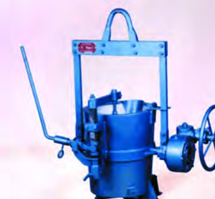
Bottom Pouring Ladle
