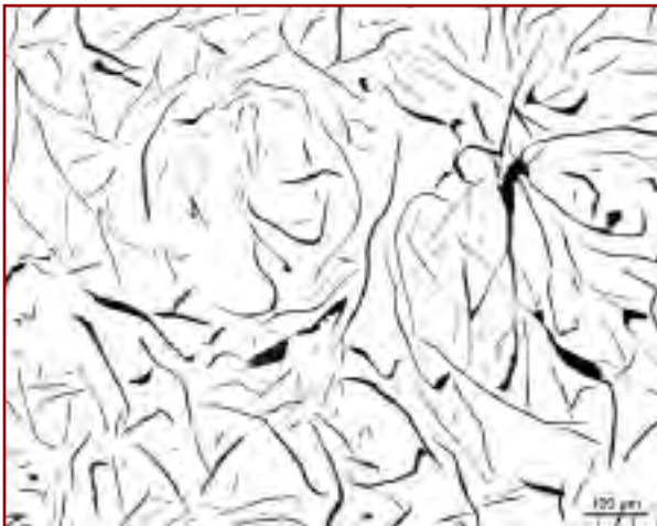
Fig. 7. Distribución de grafito en la parte inferior del disco: inoculante grafitico (a) e inoculante en base FeSi (b). Ref. AZTERLAN.
