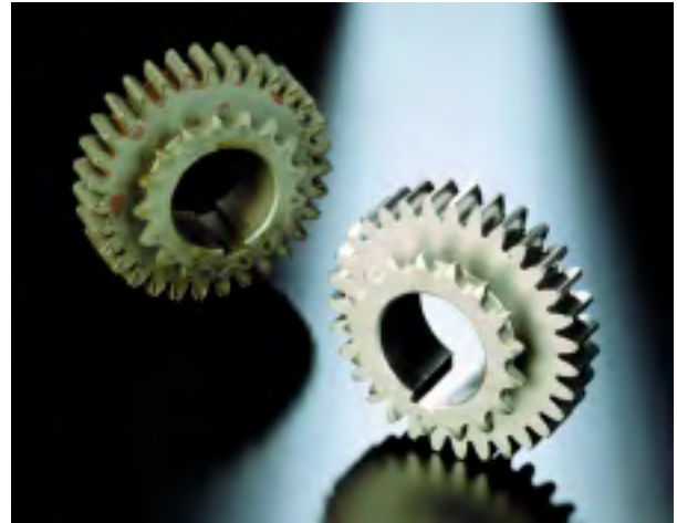
Ejemplo de pieza antes y después del shot-peening.
