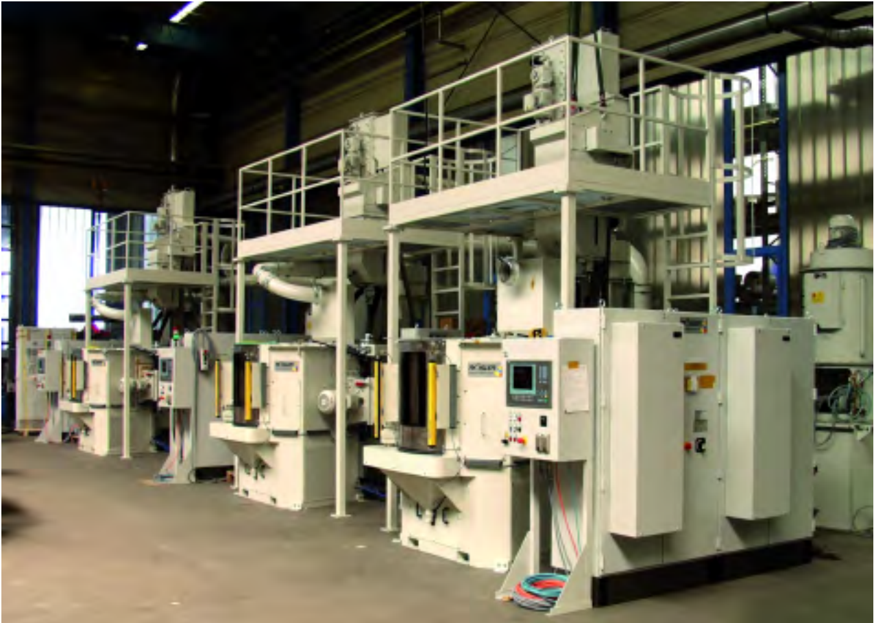
Excelente efecto peening – este sistema permite niveles de tensión compresiva de hasta 1.200 Mpa.
