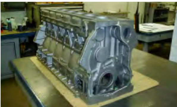
Fig. 11. Bloque cilindro MAN D20 según ISO 16112/JV 450. Poner atención especial a los cojinetes, fundidos en una pieza. Ref. MAN, Nuremberg.
