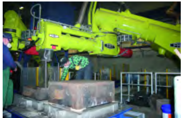
Figura 4. Estación de mezcla.
