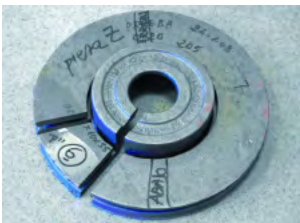
Fig. 5. Disco de freno ventilado en ensayo: Parte superior - izquierda, parte inferior - derecha, área de muestra - 6. Ref. Lingotes Especiales S.A. y AZTERLAN.
