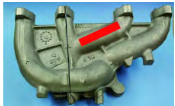
Fig. 9. Colector de escape ISO 16112/JV-400. Primera pieza de CGI ensayada.
