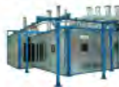
INSTALACIONES PARA EL PINTADO DE PIEZAS DIVERSAS
