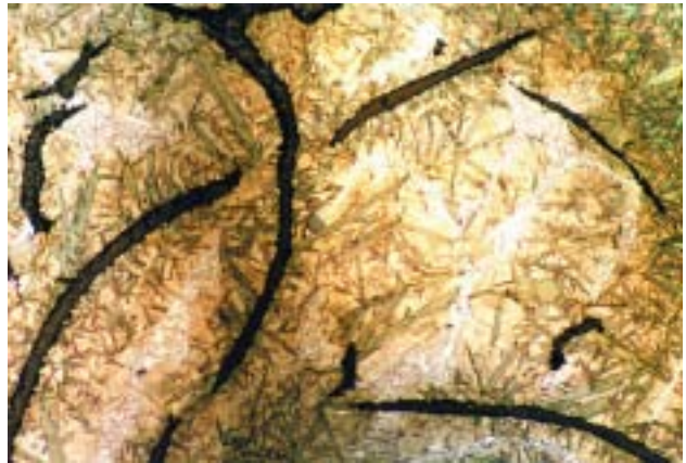
Temple en aceite: Martensita y bainita. Dureza 765 Hv.
