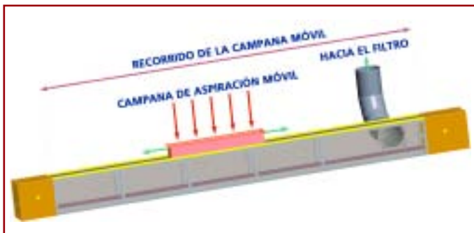
Foto 1. Conducto de aspiración con la toma fija que lo une al filtro, y la móvil que lo conecta con la grúa.
