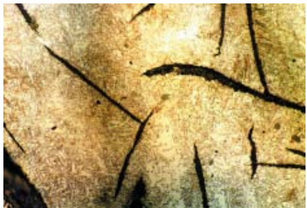
Temple isotérmico: Bainita y austenita retenida. Dureza 314 Hv.
