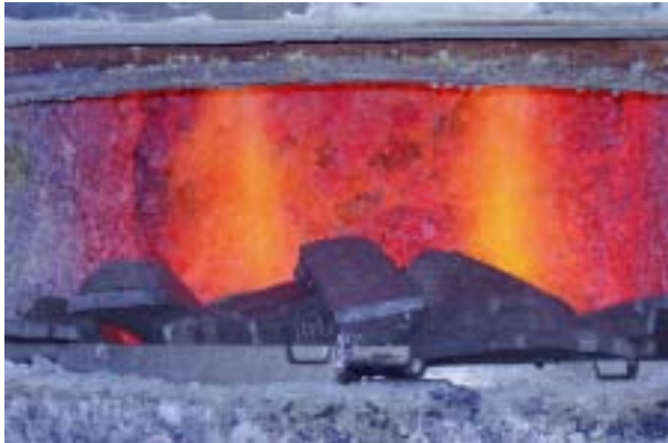
Fig. 3. Horno de fusión de aluminio en régimen de carga máxima. El horno está dotado de lingotes de aluminio. Funciona con dos quemadores Elster Kromschroder ZIO 165, potencia nominal por quemador 630 kW.
