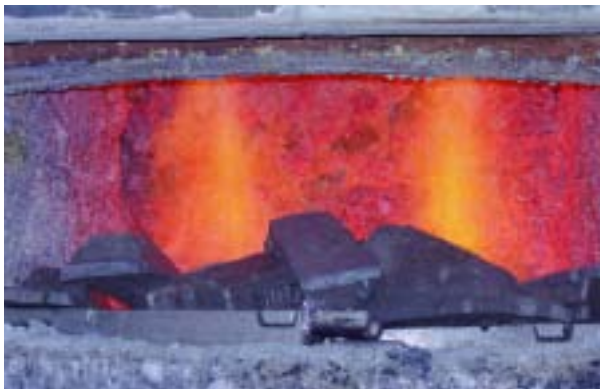
Fig. 4. Horno de fusión de aluminio en régimen de carga mínima. El horno está dotado de lingotes de aluminio. Funciona con dos quemadores Elster Kromschroder ZIO 165, potencia nominal por quemador 630 kW.
