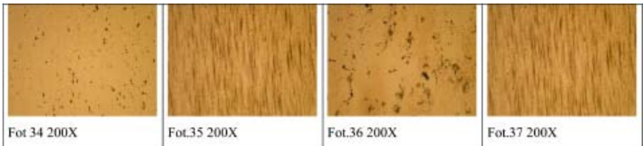
Leyenda: Aleaciones de aluminio de forja y laminación con tratamiento térmico. Fot. 34. Al-6061 con tratamiento T4, Fotografía 35. Al-6061 con tratamiento T6, Fotografía 36. Al-7075 con tratamiento T7351, Fotografía 37. Al-7075 con tratamiento T6.
