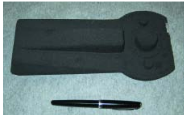
Figura 6. Macho con un 100% de arena reciclada. (Cortesía de FURESA S. COOP.).
