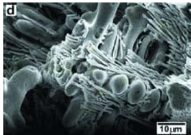
d) Crecimiento de los carburos eutécticos entre los brazos dendríticos.
