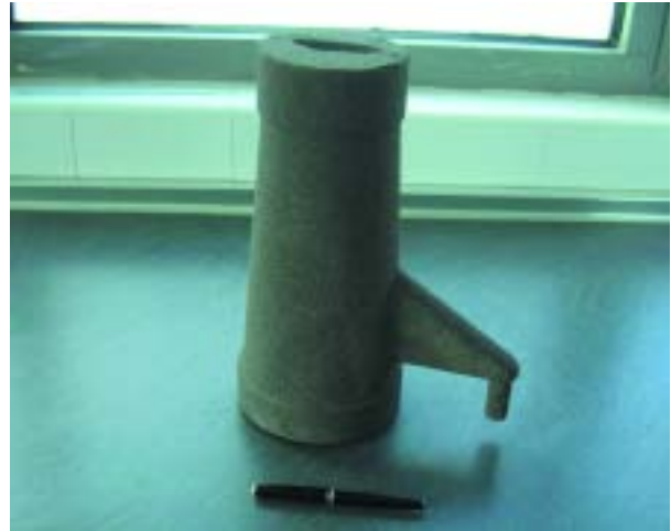
Figura 5. Macho con un 60% de arena reciclada. (Cortesía de F. GARBI S.A.).
