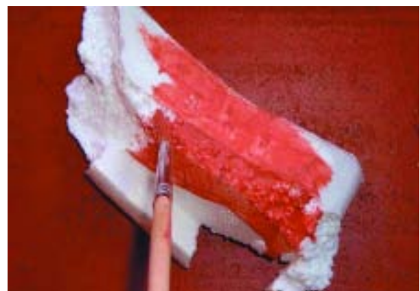
Figura 6. Pintura refractaria sobre Poliestireno expandido.
