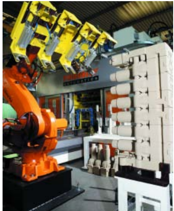
Paquete machería ensamblado por un sistema UNICORE.
