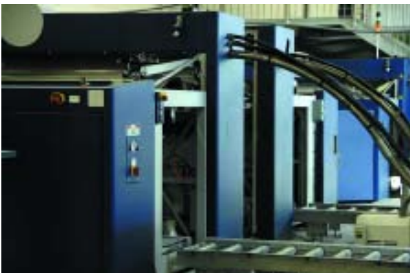
En voxeljet, seis grandes sistemas de impresión S15 procesan hasta 27 toneladas de arena a la semana.
