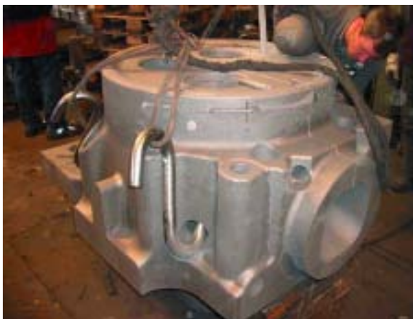
Molde de fundición de arena para culata de cilindro gran diesel.
