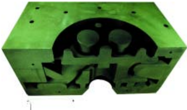
Culata de cilindro gran diesel fundida.
