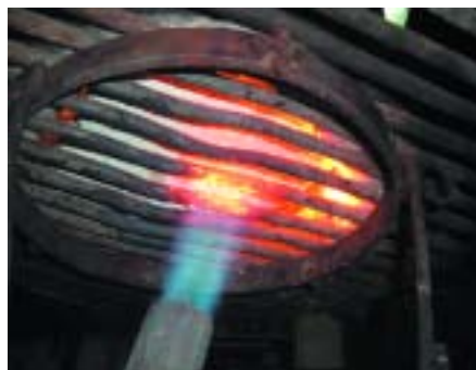
Figura 15. Cocción del molde. Choque térmico para pasar a estado cerámico.
