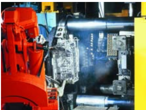
Figura 4: Extracción automática del bloque motor bimetálico de la máquina de inyección.
