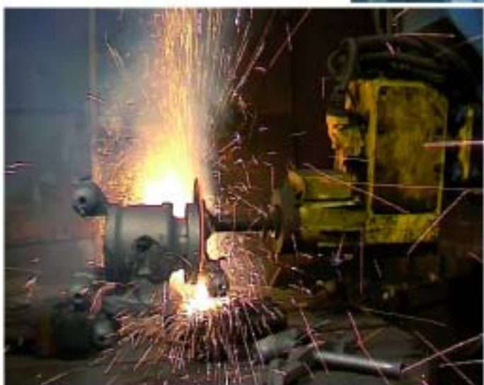
Manipuladores para corte y rebabado de piezas.
