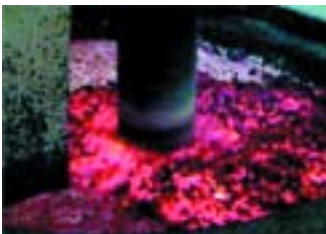
Figura 5. Acción de un fundente de limpieza.
