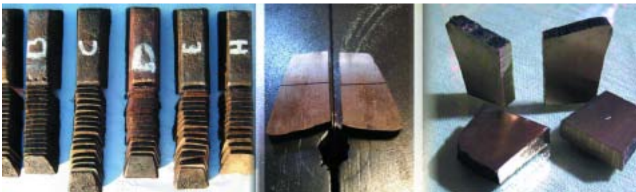
Figura 1. (Izquierda). Lingotes de bronce empleados en el presente estudio. Se observan los diferentes seccionados transversales y la nomenclatura alfabética de cada lingote, en función de su composición. (Centro-derecha). Corte longitudinal de las secciones transversales hasta la obtención de las probetas unitarias.
