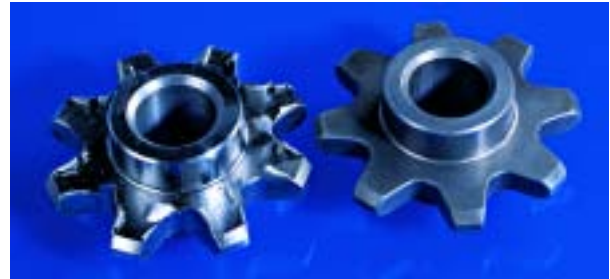
Un piñón antes y después de un desbarbado TEM. Todas las rebabas se eliminan de forma fiable en una fracción de segundo.
