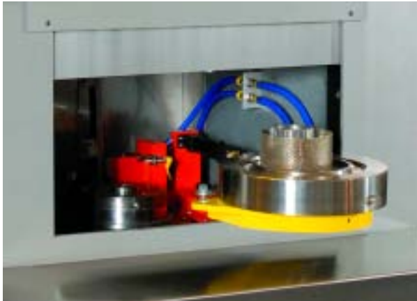
Un brazo articulado nos brinda una económica y rápida carga y descarga de la cámara de combustión.
