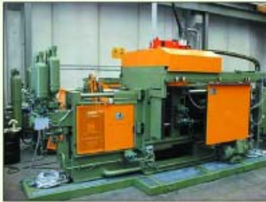
Máquina de cámara fría de 400 Ton de fuerza de cierre
