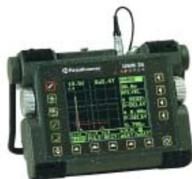
Equipos de UT
