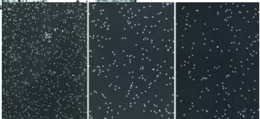
Figura 1. Variación de la estructura desde la superficie de la pieza (izquierda) hasta la zona central de la pieza.
