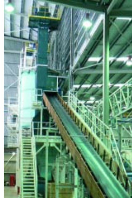
Línea de preparación de arenas Producción: 120 t/h
