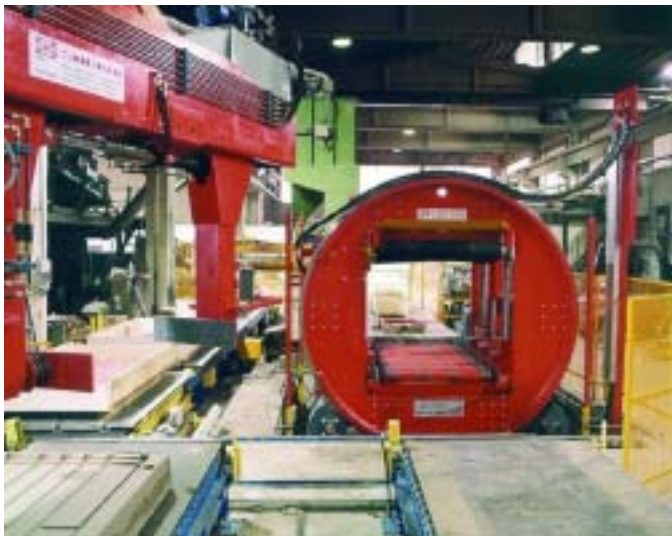
Línea de moldeo sin caja y con caja para el proceso "no-bake"
