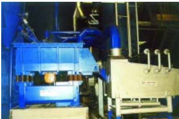
Instalación de recuperación mecánica de arenas "no-bake"
