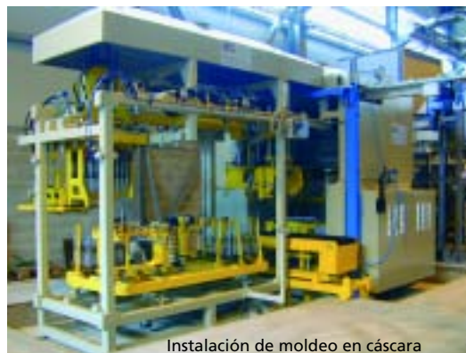
Instalación de moldeo en cáscara
