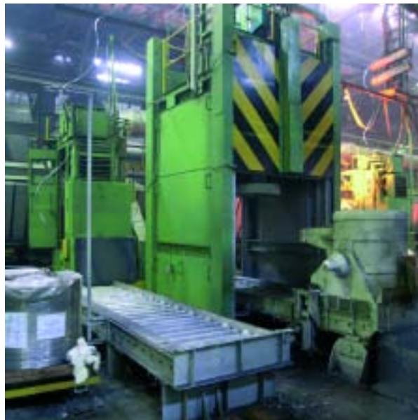
Estación de nodulización mediante hilo con cabina
