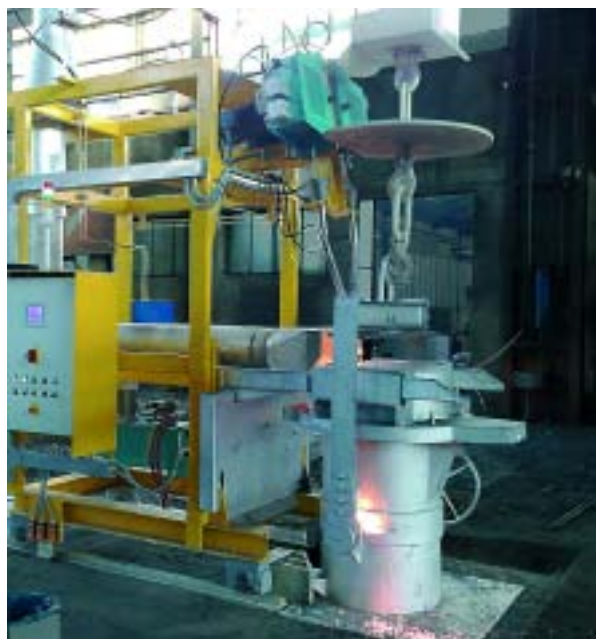
Estación de nodulización con hilo
