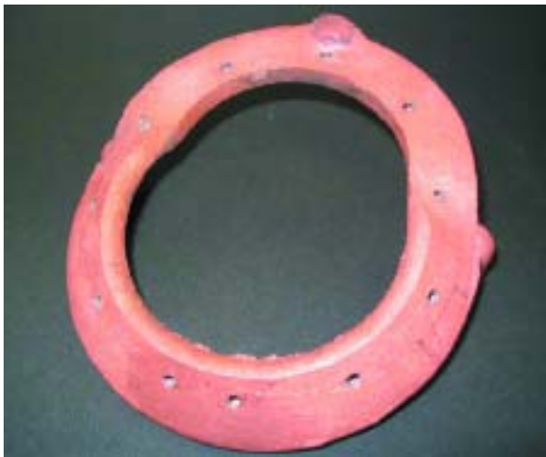
Figura 1. Pieza obtenida en la colada.
