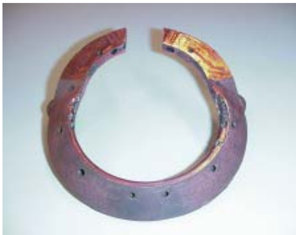
Figura 4. Pieza pulida que muestra los defectos de llenado.
