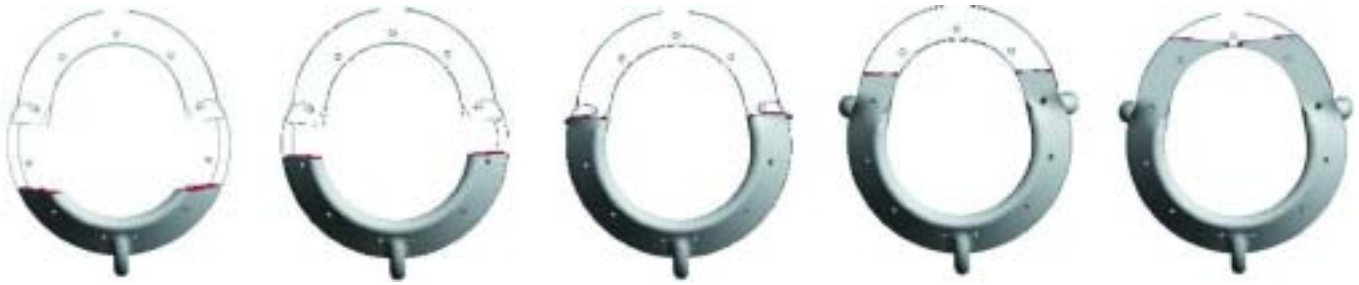
Figura 9. Secuencia de llenado de la pieza en la cual se aprecia en rojo la superficie libre del metal líquido, y en gris la parte de la pieza ya llena.
