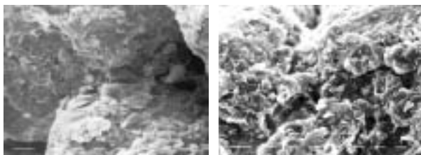
Figura 9. Imágenes SEM de la arena sin tratamiento.
