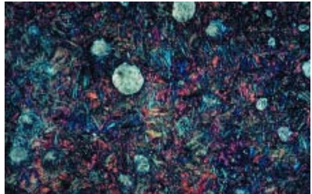
Fundición ADI. Ataque térmico. Ausferrita inferior.
