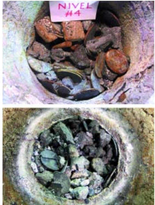
Figura 7. Vista general de las condiciones de los materiales de carga luego del enfriamiento del horno. La primera figura corresponde al Nivel 4, la segunda al Nivel 9.
