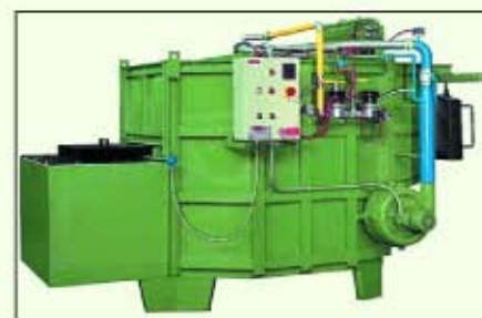
Horno de fusión y mantenimiento de cámara
